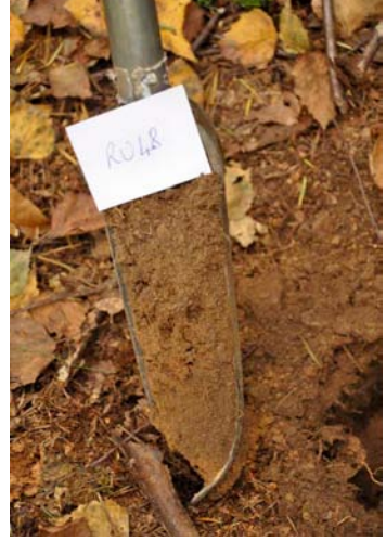
Prélèvement des vingt premiers centimètres de sol à la tarière.
