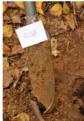
Photographie 1. Prélèvement des vingt premiers centimètres de sol à la tarière.
